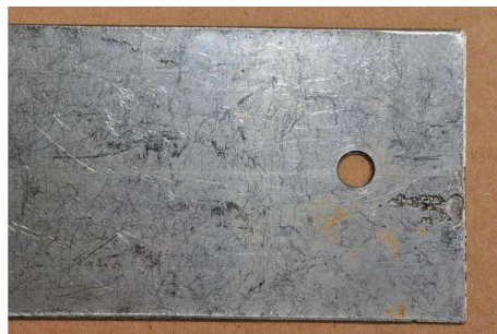
4301-plade (t = 0,5 mm) efter simpel korrosionstest: En sur opløsning af NaCl + H 2 O 2 ; 20 °C, 4 døgn
