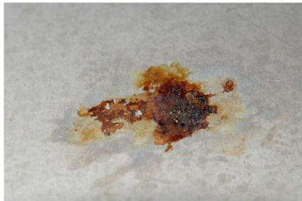
Grubetæring i tank af 4307 udsat for lunkent postevand
